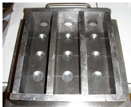
Figure 4.18 : Moule de fabrication des assemblages de traction au plot collé
